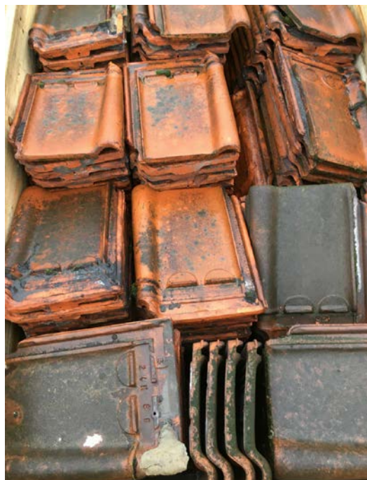
Aspect esthétique des tuiles après démontage d'une toiture © Wienerberger
