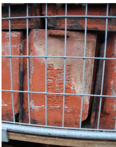
Exemple d'indication de la provenance d'une tuile au dos de celle-ci (© Buildwise)
