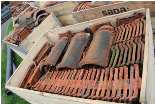
Exemple de stockage de tuiles en vue de leur réemploi
