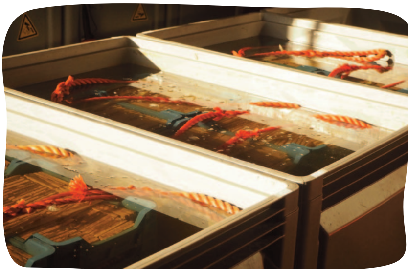
Schoonmaken van keramische tegels door middel van weken. Ook hier is het doel van de reiniging het verwijderen van mortelresten aan de randen en de binnenkant van de tegels.
