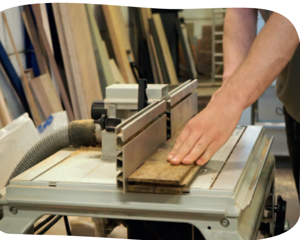
Reinigen van de groef van parketstroken, na het snijden ervan, om de afmetingen aan te passen aan hun nieuwe bestemming.
