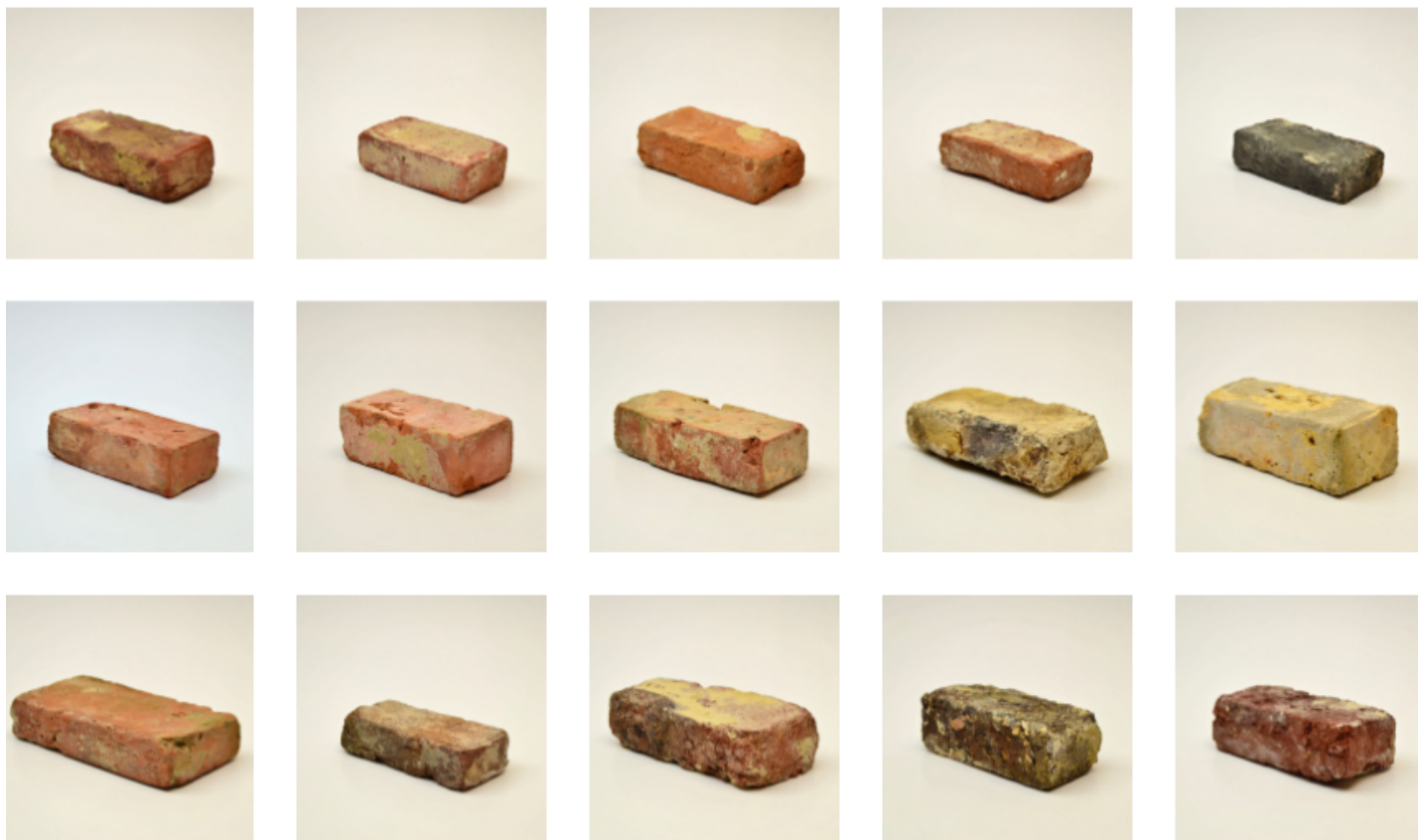
Varieties of reclaimed bricks on the Belgian market. From g. to d., from the top: 1. (Boomse) Handmade Klampsteen or Klinkaard (rijnvorm). 2. (Boomse) Klampsteen or Klinkaard handmade (derdeling). 3. Papesteen (rijnvorm). 4. Papesteen (derdeling). 5. Blue papesteen (derdeling). 6. Beerse steen or machinale Klinkaard (rijnvorm). 7. Beerse steen or mechanical Klinkaard (Beerse 65). 8. Beerse steen or mechanical Klinkaard (waalfmaat). 9. Handmade Poldersteen (moef) or Brugse moef/poldersteen. 10. Damse Poldersteen (moef) or Damse (abdij) moef, Kuststeen. 11. Spaanse moef. 12. Brusselse Klampsteen. 13. Scheldesteen. 14. Scheldesteen (dik). 15. Veldovensteen.
